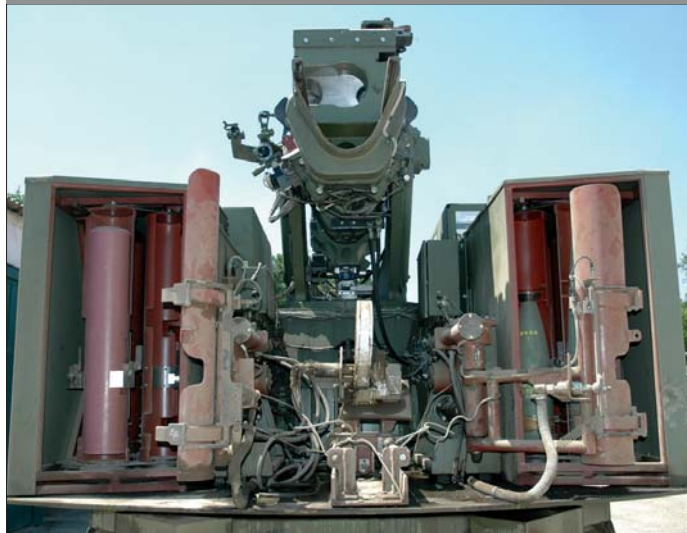
Аутоматски пуњач садржи два магацина са носачима муниције смештеним са обе стране оруђа
